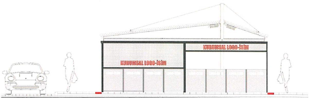
İşletme yan cephesinde "Kanallı Profil" cam tutuculu seperatör uygulaması
